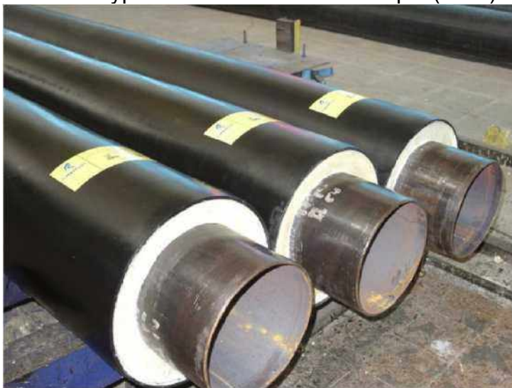
Рис.10.Теплоизоляция ППУ «скорлупа»
