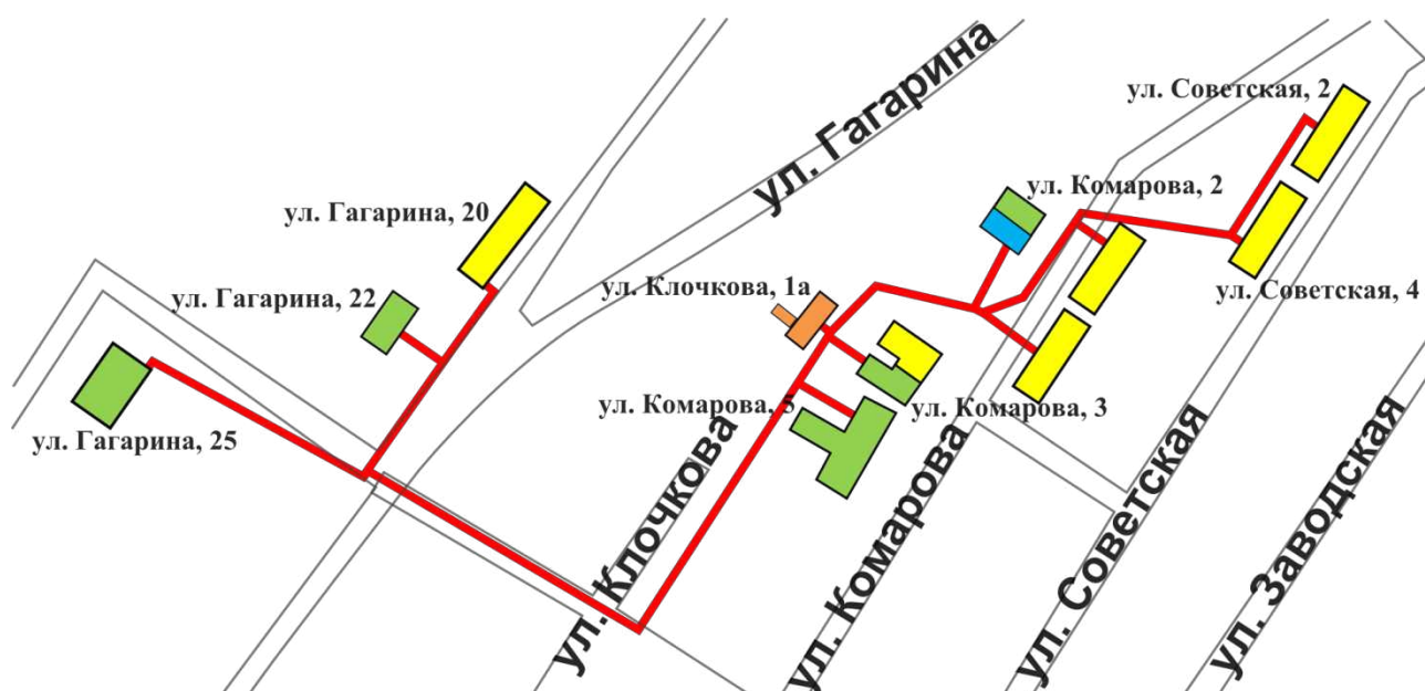
Рисунок В – Карта-схема тепловых сетей МУП ТС «Ремовский» в зоне действия котельной п. Ремовский
