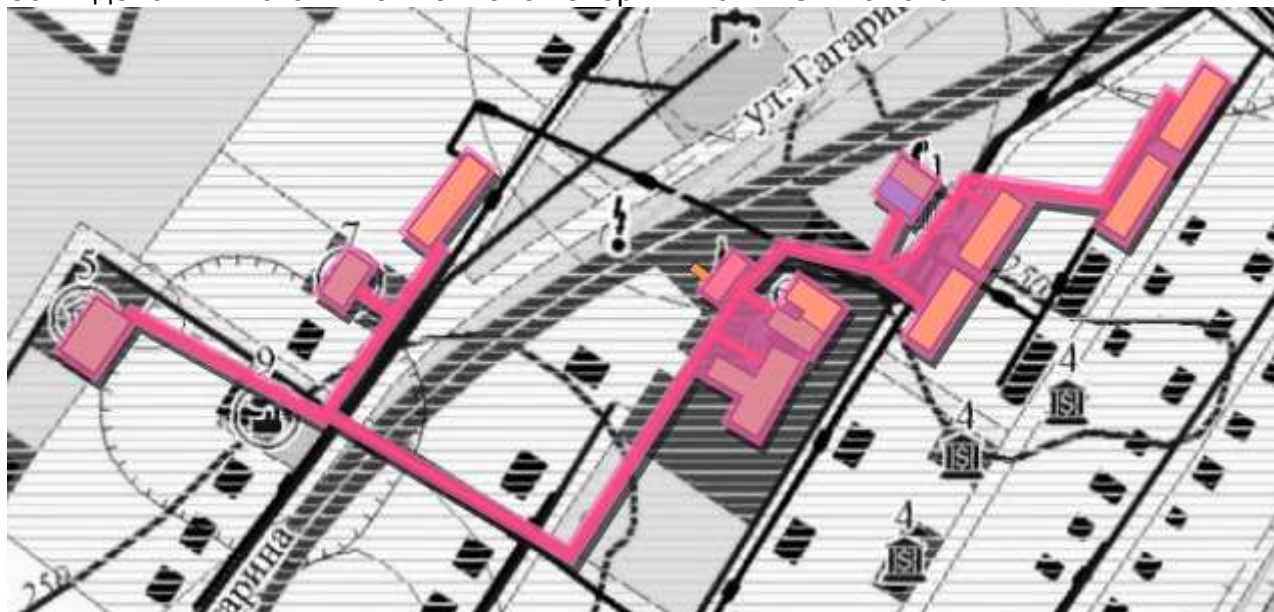
Рисунок Б – Зона действия котельной п. Ремовский МУП ТС «Ремовский» на территории п. Ремовский Ремовского сельсовета Локтевского района Алтайского края
