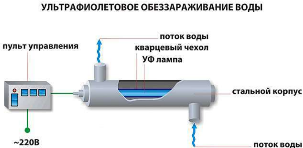
Рисунок 3 – Схема ультрафиолетовое обеззараживание воды
